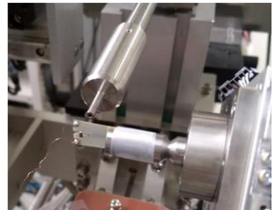
図 1 電場印加下における回折実験の様子
