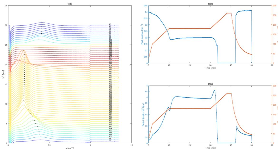
図 1 (左) iPP を室温から 180°C まで昇温して保持したときの SAXS プロファイル ( $Iq^2$  vs.  $q$ ) 及び (右 上) ピークの位置と (右 下) 高さ
