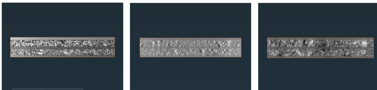
Fig1. リチウムイオン電池正極材の 3 次元構築データの断面画像。左から、プラズマ FIB、ラボ X 線 CT、BL8S2 で取得したデータ。
