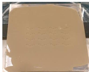
図 1: 基板に接着したアクリル板に製作したパタン型の写真
