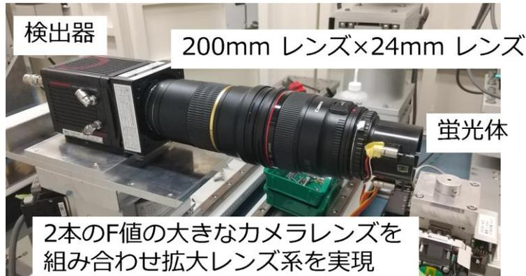
図. 1 カメラレンズを使用した高倍率 X 線 CT 撮影装置
