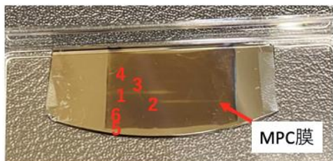
Fig.1 異なるスキャン速度で複数箇所を XRR 測定した後の MPC 膜の写真。
