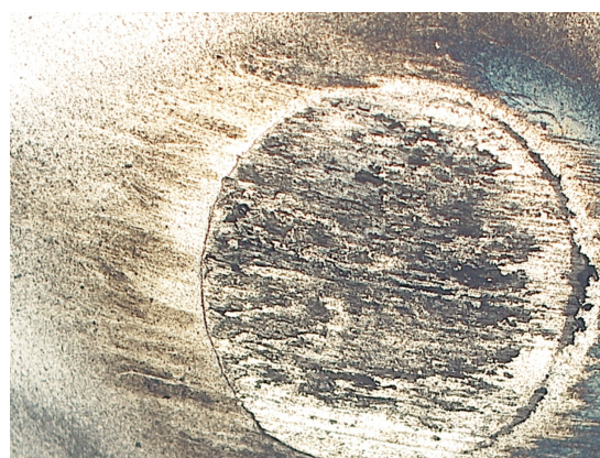
Fig. 2 試験後の摩耗痕の様子（サンプル F）
