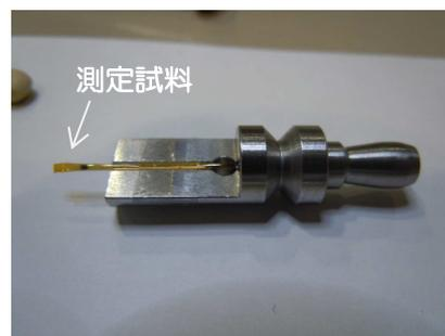
Fig.1 測定試料をホルダーに装着した様子。先端の黒い点が測定試料。
