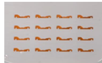
電鍍処理で製作した基板 上の試料ピン部の写真
