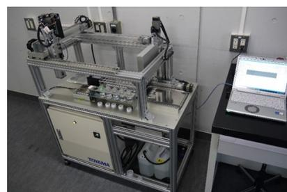
Fig.1 重点M3において構築したコンビナトリアル合成装置
