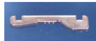
図：LIGA プロセスで作成したはやぶさ試料ピン
