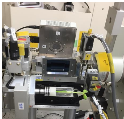
図 1：XDFI-CT 装置による 接木植物の測定風景
