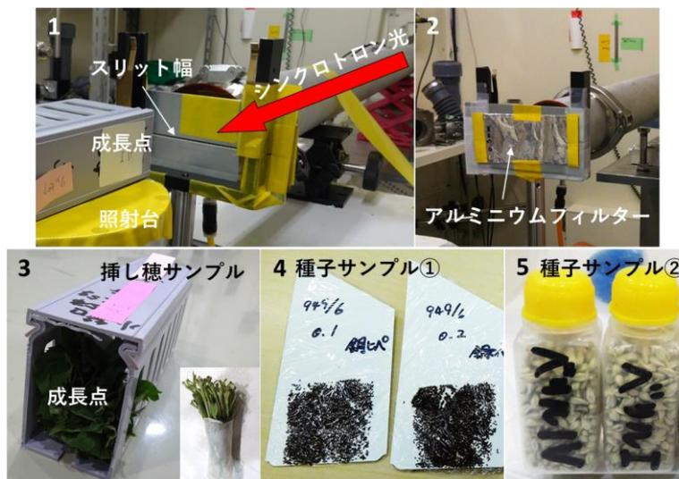
Fig.1 照射方法及びサンプルの調整方法
