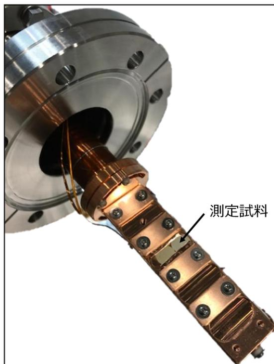
Fig.1 低温測定用試料ホルダー
