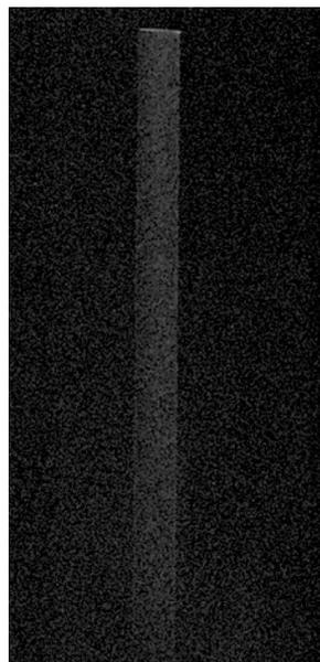
観測された、厚い結晶での動力的回折の回折波像。白黒の濃淡が X 線強度に対応している。
