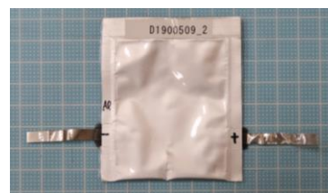
図 1 シングルセル Li イオン電池の外観 正極 : \text{Li}(\text{NiMnCo})\text{O}_2 負極 : 人造黒鉛 電解液 : \text{LiPF}_6/\text{EC}/\text{EMC}/\text{DMC}
