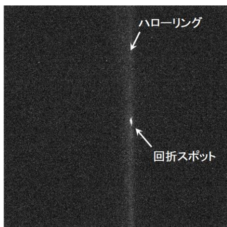
Fig.1 多結晶 3C-SiC 内の一つの結晶粒からの回折像。
