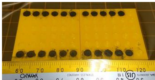
Photo 1 粉体を充填しポリイミドテープで被覆した反応基板
