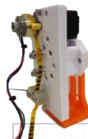
Fig.2 放射光 XRD 測定治具
