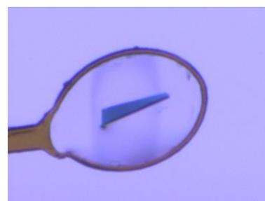
図 1. 赤色光吸収 Pr 型結晶 (データ収集後)
