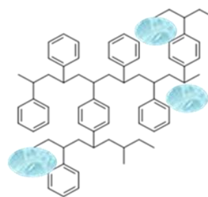
Fig. 1 抽出クロマトグラフィーに用いられる吸着材のイメージ
