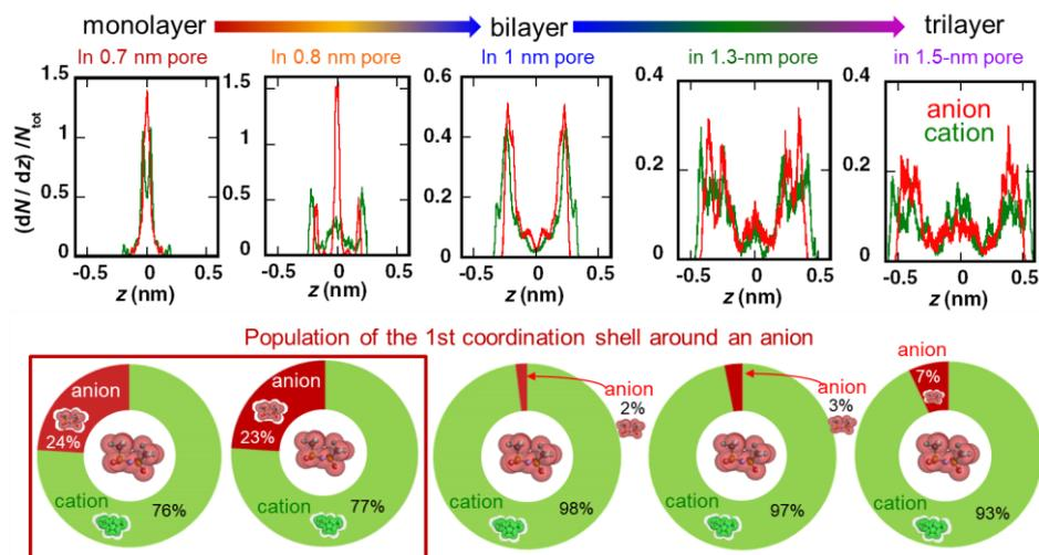
図 2 HRMC シミュレーションから得た、それぞれのカーボン細孔中におけるイオンの細孔径方向の分布 (上) とアニオンの第一配位圏に存在するそれぞれのイオンの割合 (下)
