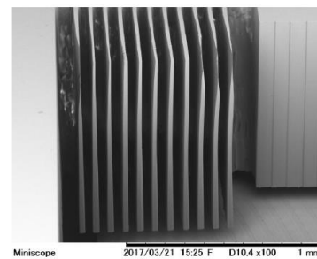
Fig.1 - c 高アスペクト比パターン
