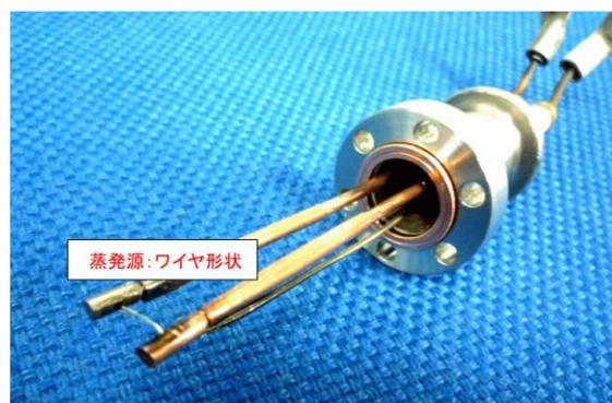
Fig.1 ナノ粒子金属の蒸発源
