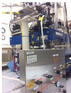
写真左：ガス配管付き 3 連式セル
