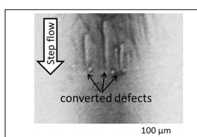
図 1. マクロステップ形成部分における放射光 X 線トポグラフィ像。貫通転位が変換することにより形成する基底面転位のコントラストが観察された。
