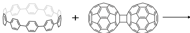
Fig.1 カーボンナノリング[10]CPP-ダンベルフラーレン C 120 複合体の合成スキーム
