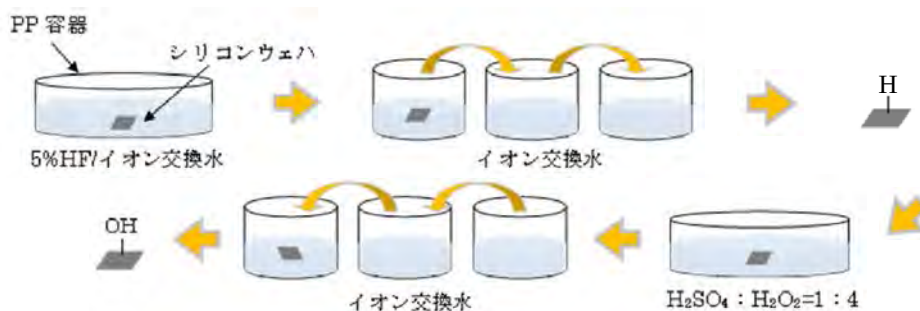
Fig.2 Si-HとSi-OHの終端処理プロセス
