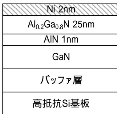
図3 評価に用いた試料構造
