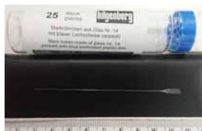
Fig.1 回折実験用試料キャピラリー
