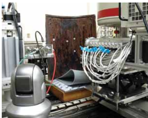
写真2：大型掛唐草瓦の測定 あいちSRセンター 試料部位 karakusaR・K2・K・R2を白丸シールで示している。（測定結果は図1）
