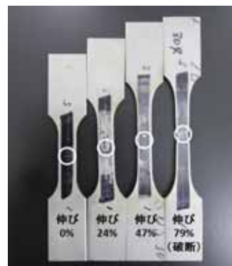
図1 試験片概観 (SUS304)
