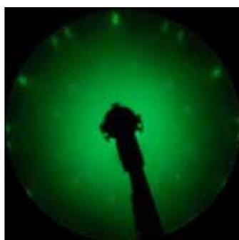
**Fig.2** Si(111)  $\sqrt{3} \times \sqrt{3}$ -B 基板表面上に形成した Bi(110) 超薄膜表面からの LEED パターン。加速電圧：38eV。
