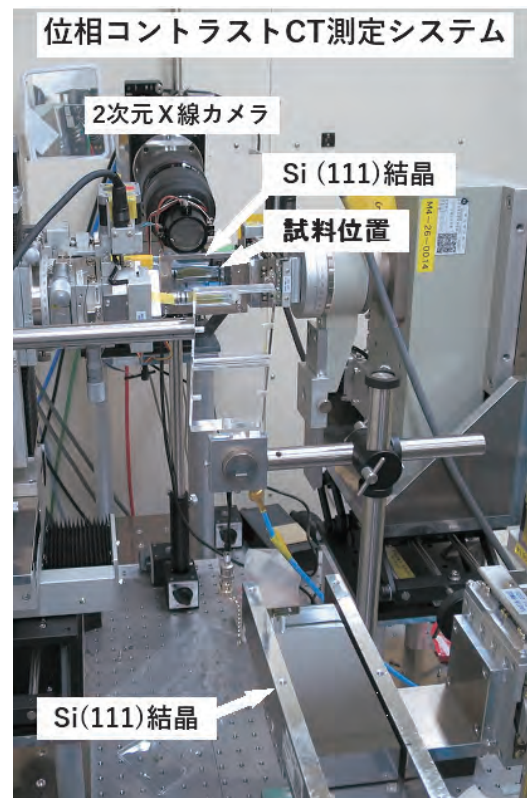
図 20 導入中の位相コントラスト CT 測定システム
