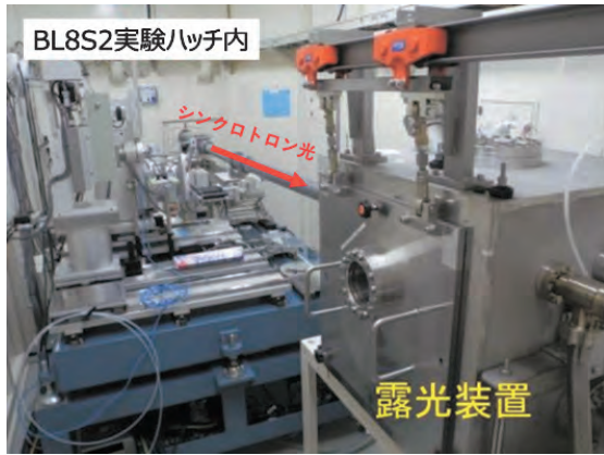
図3 BL8S2 実験ハッチ内の露光装置 装置内に He ガスを充填して露光を行う。 露光装置のサイズは 60 cm × 60 cm × 60 cm
