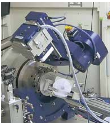
残留応力測定（側傾法、2D 検出器使用）
