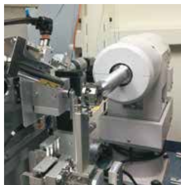
BL2S1 の回折計のゴニオに 3 種類の DAC を搭載した様子
