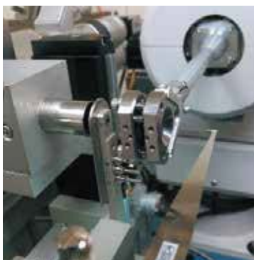
BL2S1 の回折計のゴニオに 3 種類の DAC を搭載した様子
