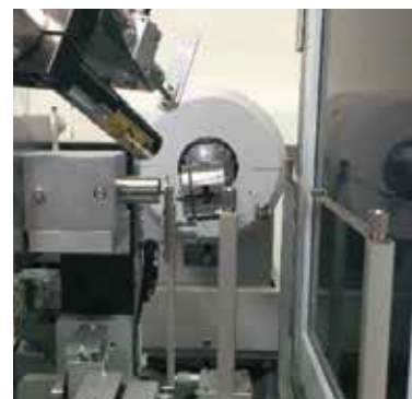
BL2S1 の回折計のゴニオに 3 種類の DAC を搭載した様子
