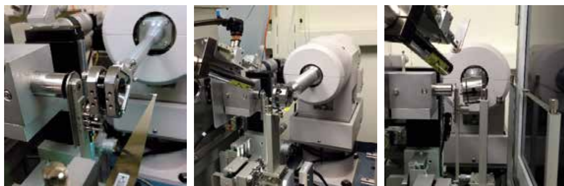
BL2S1 の回折計のゴニオに 3 種類の DAC を搭載した様子
