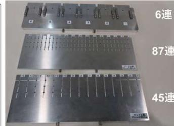
6連、45連および87連のサンプルチェンジャーが完備されており、試料サイズおよび形態によりサンプルチェンジャーを選択し、測定の自動化が可能
