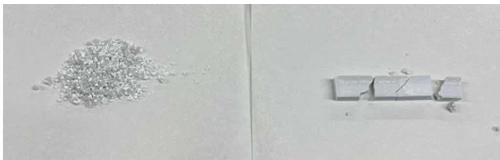
(a) 完全に崩壊したジオポリマー (b) クラックが入って割れたジオポリマー
