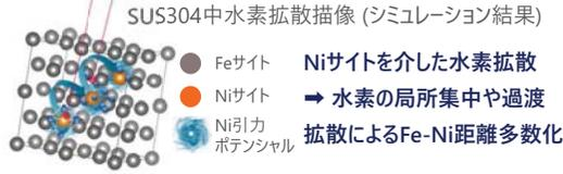
実験ではNi-H距離は観測不可、Fe-Ni距離を実測し水素拡散現象を解明へ
