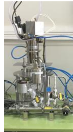
開発したナノカーボン合成装置
