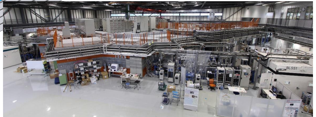
1辺50mのホールに設置された 周長72mのシンクロトン光源
