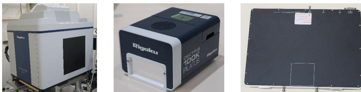
図5 BL8S3 で利用できる 2 次元検出器 (左から R-AXIS IV++, PILATUS 100K、Flatpanel)
