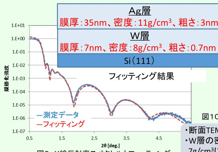
図9 X線反射率スペクトルとフィッティング
