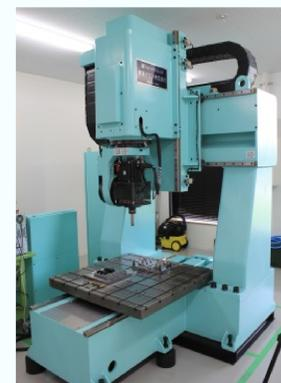
図2 5軸摩擦攪拌点接合装置
