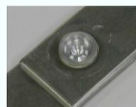
図1 摩擦攪拌点接合とは
