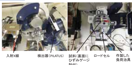
図1 BL8S1での応力負荷下XRD測定の様子
