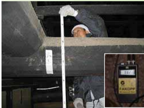
解体前に応力波伝播速度を測定します 測定器(FAKOPP)を使用し、材料(柱、梁)を測定し、データ収集後、コンピュータ解析します
