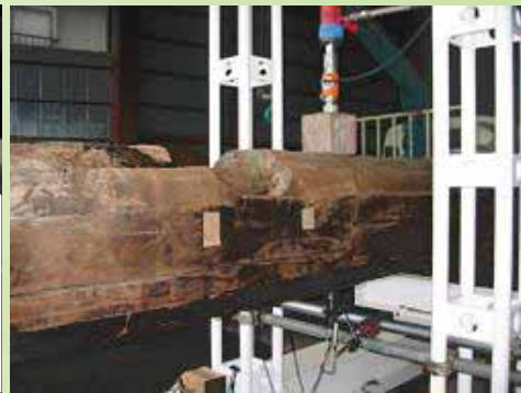
補足調査として解体後に実物大の非破壊曲げ試験調査を行いました(応力波測定値と相違ない事を確認)
