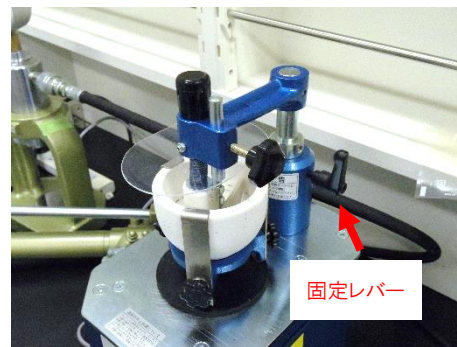
図7. 昇降シャフト固定前（左）と固定後（右）の様子
