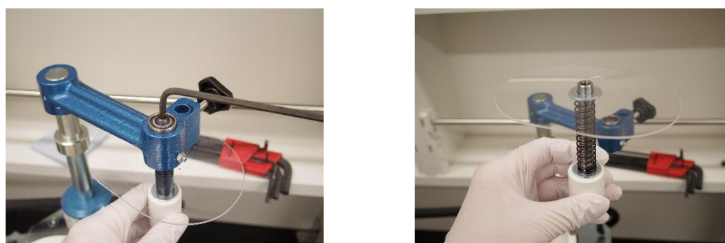
図 15. 止めネジを外す作業（左）と取り外された乳棒（右）
