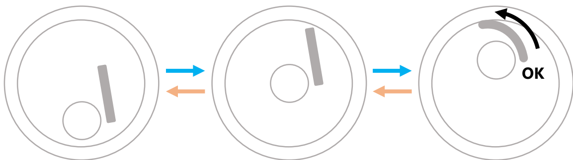
図 11. へらの角度調節が適切な場合のへらの曲がり方
