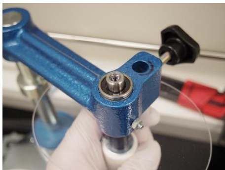
図 19. 乳棒のアームへの差し込み（左）と止めネジを締める作業（右）
