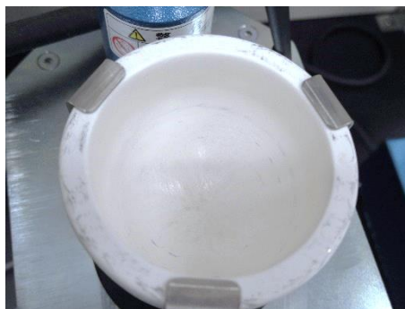
図 17. 洗浄しても除去しきれない変色等
