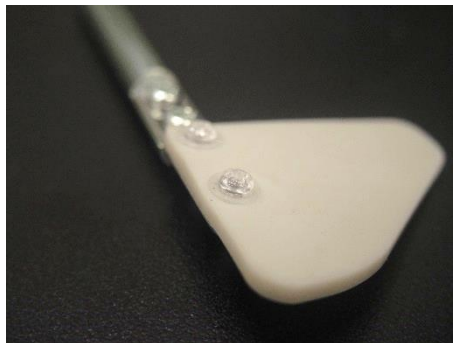
図 21. 樹脂ネジで取り付けられたシリコンヘラ
