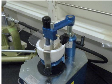
図 10. ダンシングミルによる試料と BN の混合
