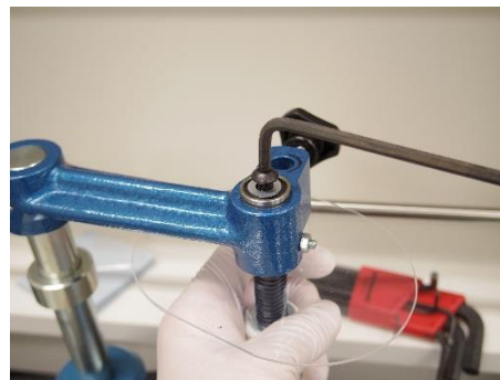
図 19. 乳棒のアームへの差し込み（左）と止めネジを締める作業（右）
